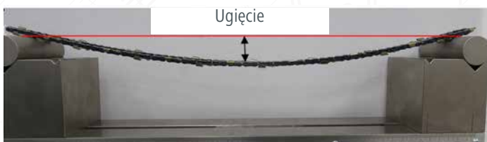
Obraz 1: Układ testowy do pomiaru ugięcia łańcuchów
